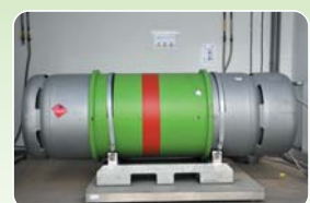
A lekondenzált környezetkárosító gázokat zárt tartályban szállítják megsemmisítésre
