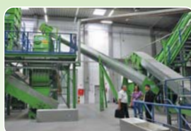
Az aprítást a láncos törőberendezés végzi
