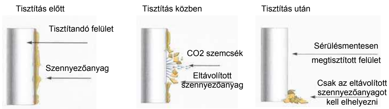
2. ábra: A szárazjégszórásos felület tisztítás elvi vázlatja
