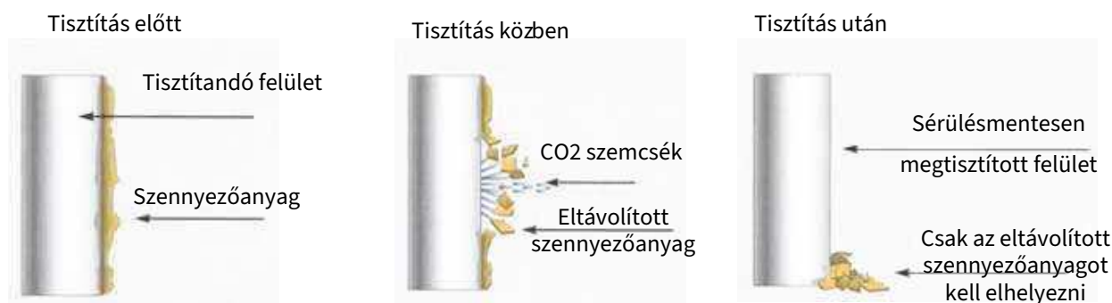
2. ábra: A szárazjégszórósos felülettisztítás elvi vázlata
