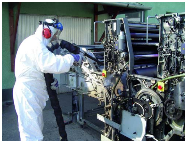
2. ábra. Makacs szennyeződések kíméletes tisztítása szárazjégszórással
