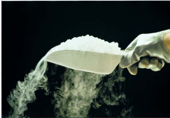
1. ábra. A szárazjég gázzá alakul át, szublimál
