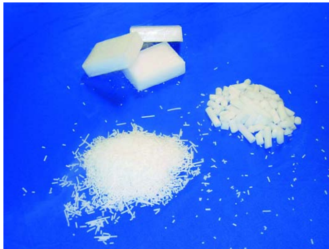
3. ábra Szárazjég blokk, granulátum és apró pellet formában
