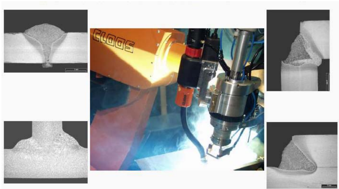
6. ábra Tompa- és sarokkötések lézer-hibrid eljárással történt kivitelezése.
