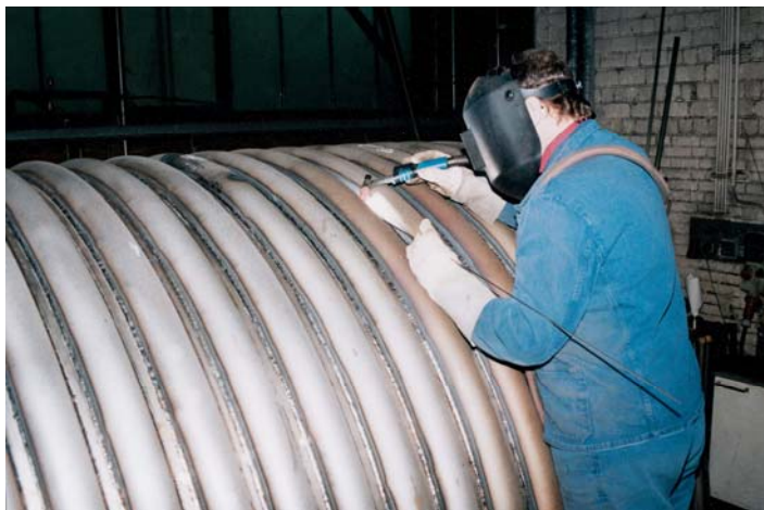
1. ábra. Csőrendszer felhegesztése AWI hegesztéssel hűtött keverőtartályra
