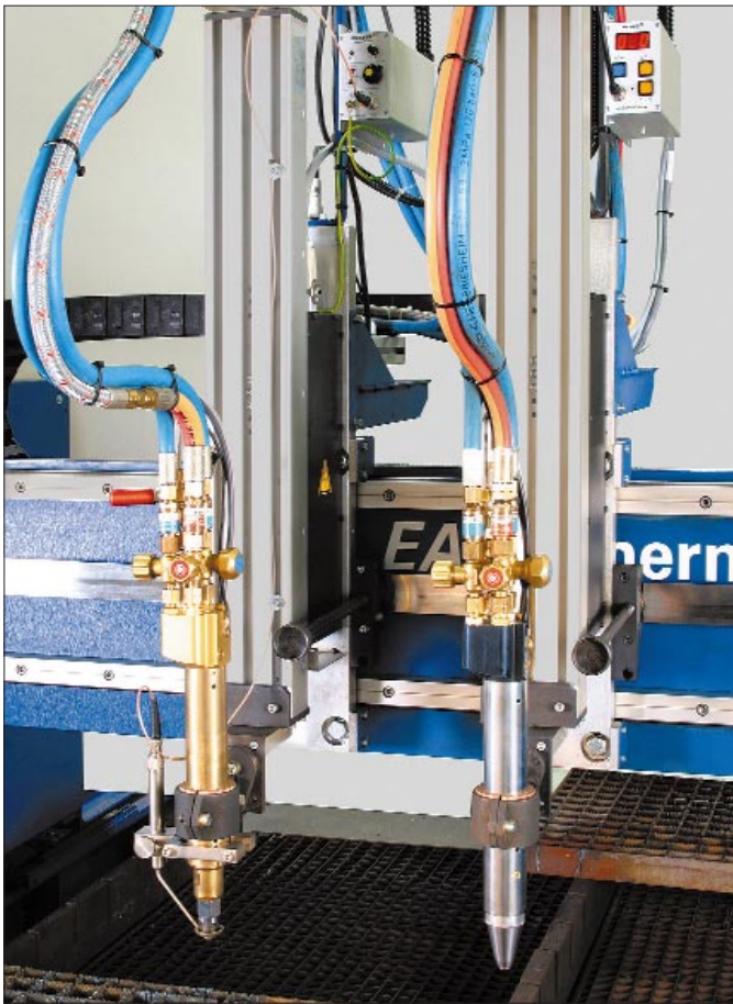
1. ábra: Hagyományos (balra) és új típusú (jobbra) vágófej összehasonlítása
