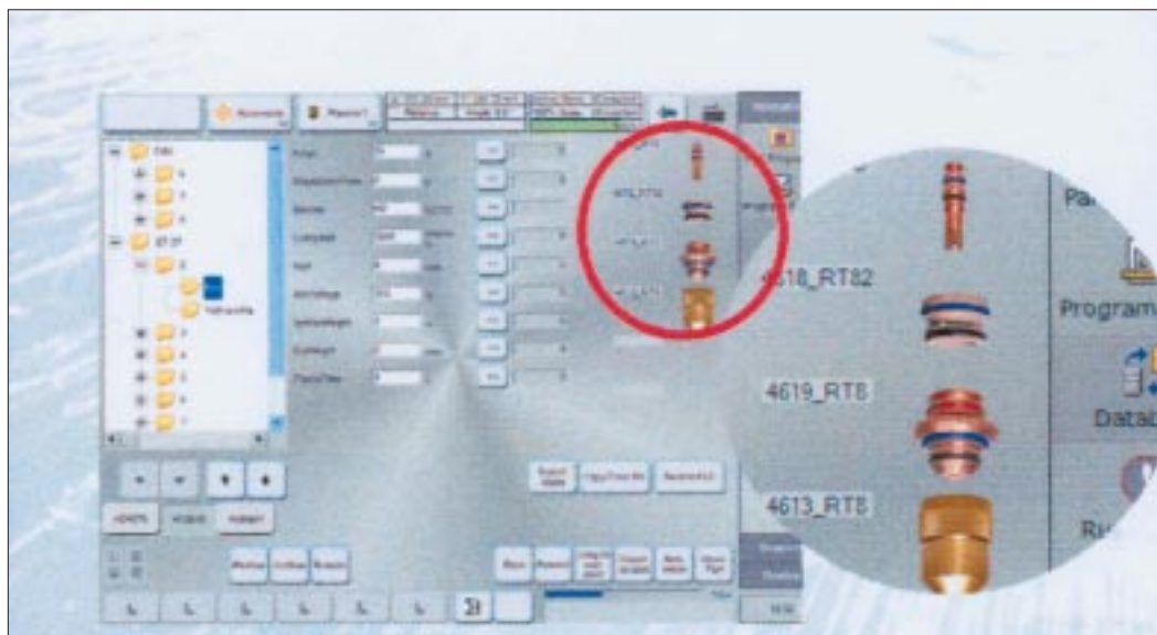
5. ábra: Vágószerszámok és cserealkatrészek képi megjelenítése a vágási adatbank segítségével, amely lehetővé teszi az alkatrészek egyszerű keresését, beazonosítását
