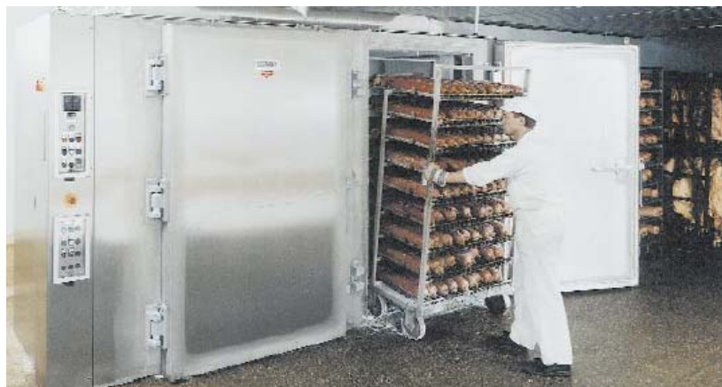
5. ábra A fagyasztószekrényén magas fagyasztási kapacitásával hűtésre és fagyasztásra egyaránt alkalmas.
