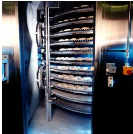
4. ábra A spirálfagyasztók magas fagyasztási teljesítményt nyújtanak kis alapterületen.
