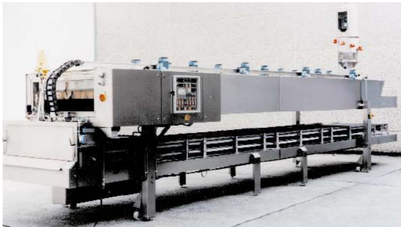
3. ábra Cryogen ® Rapid fagyasztóalagút.
