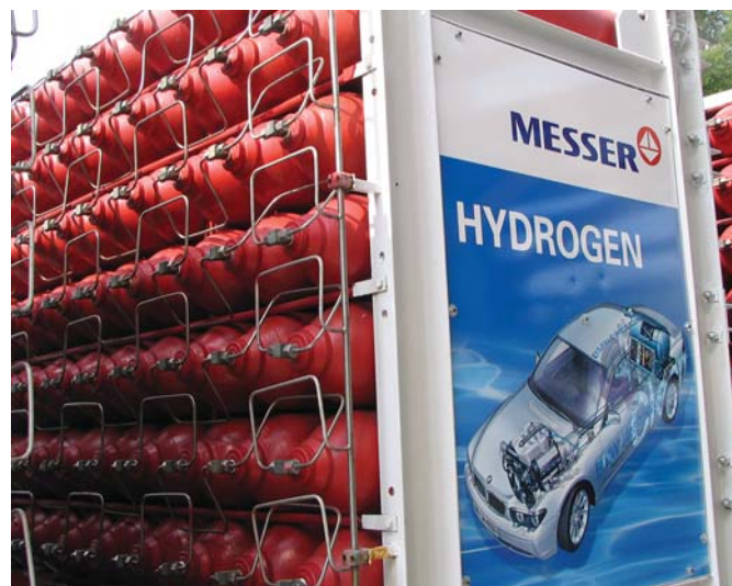
Összecsovezett hidrogén palackköteg csoportok
