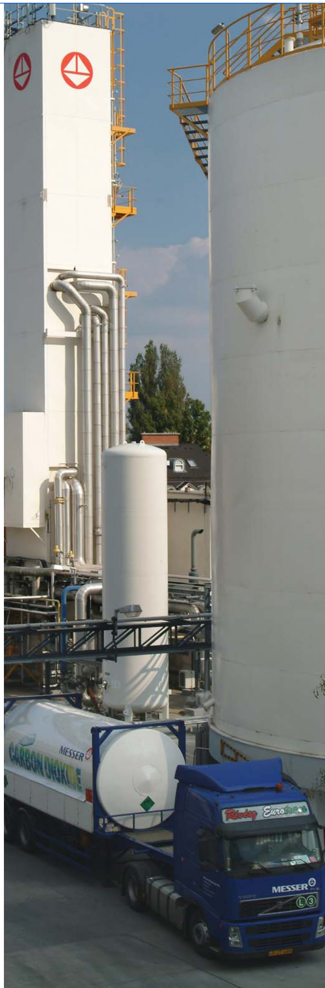
2.3 ábra Nitrogén, oxigén és nemesgázok előállítása kriogén levegőtérválasztással
