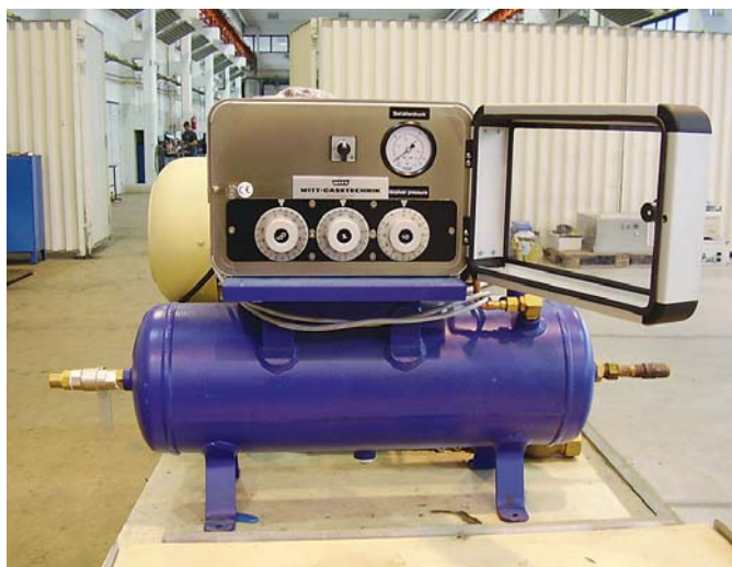
Gázkeverő berendezés háromkomponensű gázkeverék előállításához
