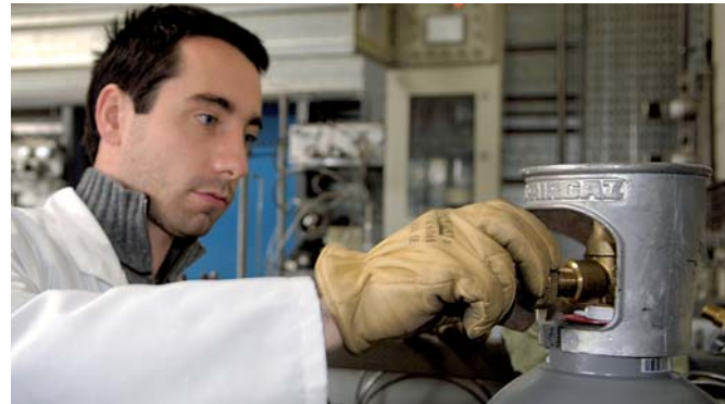
A palackszelepet, illetve más zárószerelevényt óvatosan nyissuk ki
