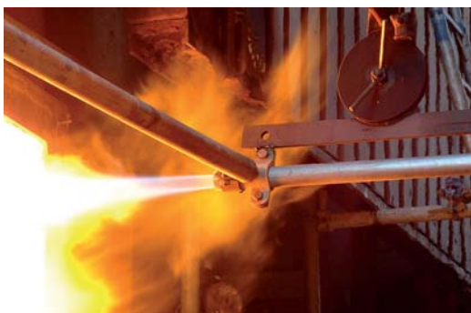
A kénsav gyártó-berendezés leállása alatt beolvasztják a képződött salakot.
