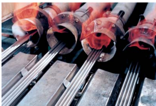
Speciális huzal nemesítése áthúzó csőkemencében
