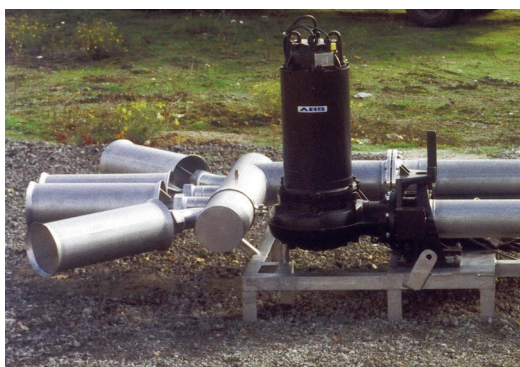
1. ábra: A Messer által kifejlesztett tisztaoxigén-beviteli eljárások: perforált gáztömlők (balra), injektor (középen), oxidátor (jobbra).
