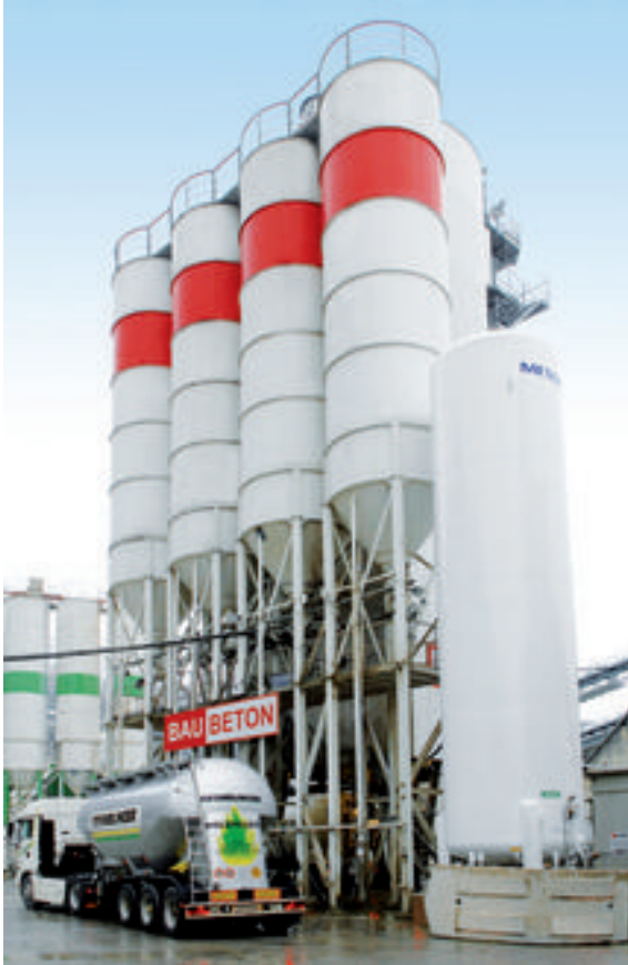
Cementhűtés Innsbruck mellett, Ausztriában.
