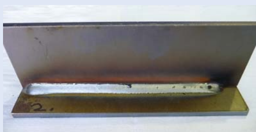
Ferroline C12X2 gázzal hegesztett varrat
