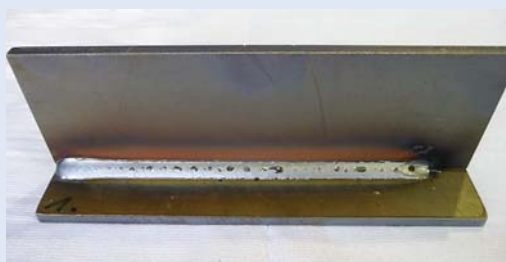
Ferroline C18 gázzal hegesztett varrat
