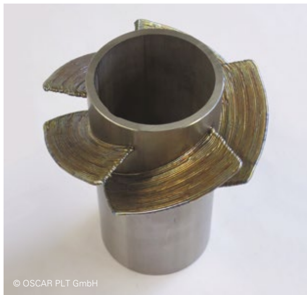
Koaxiális direkt energia felrakás huzaladagolással
