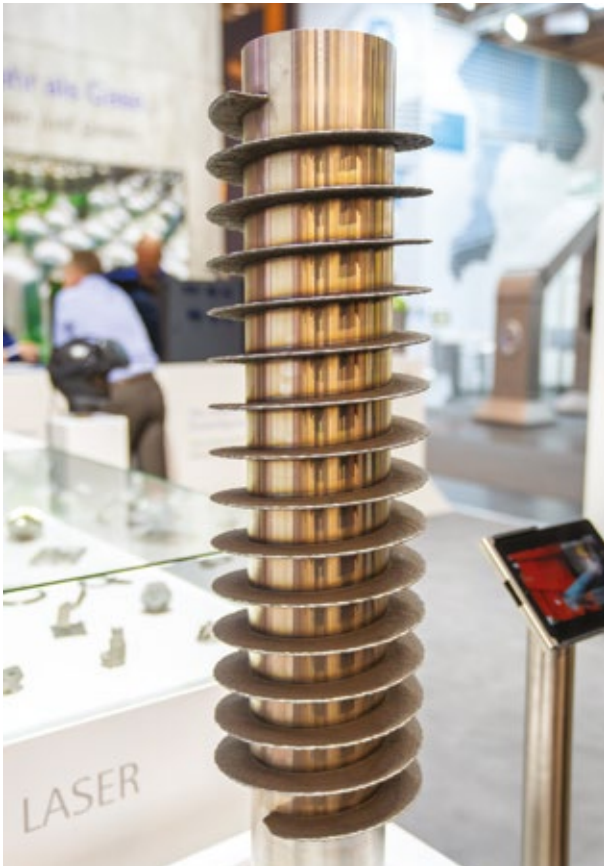
DED-LB eljárással nyomtatott szállítócsiga
