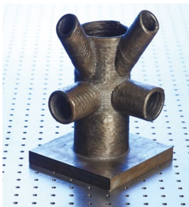
„TU Ilmenau” által gyártott acél csomópont
