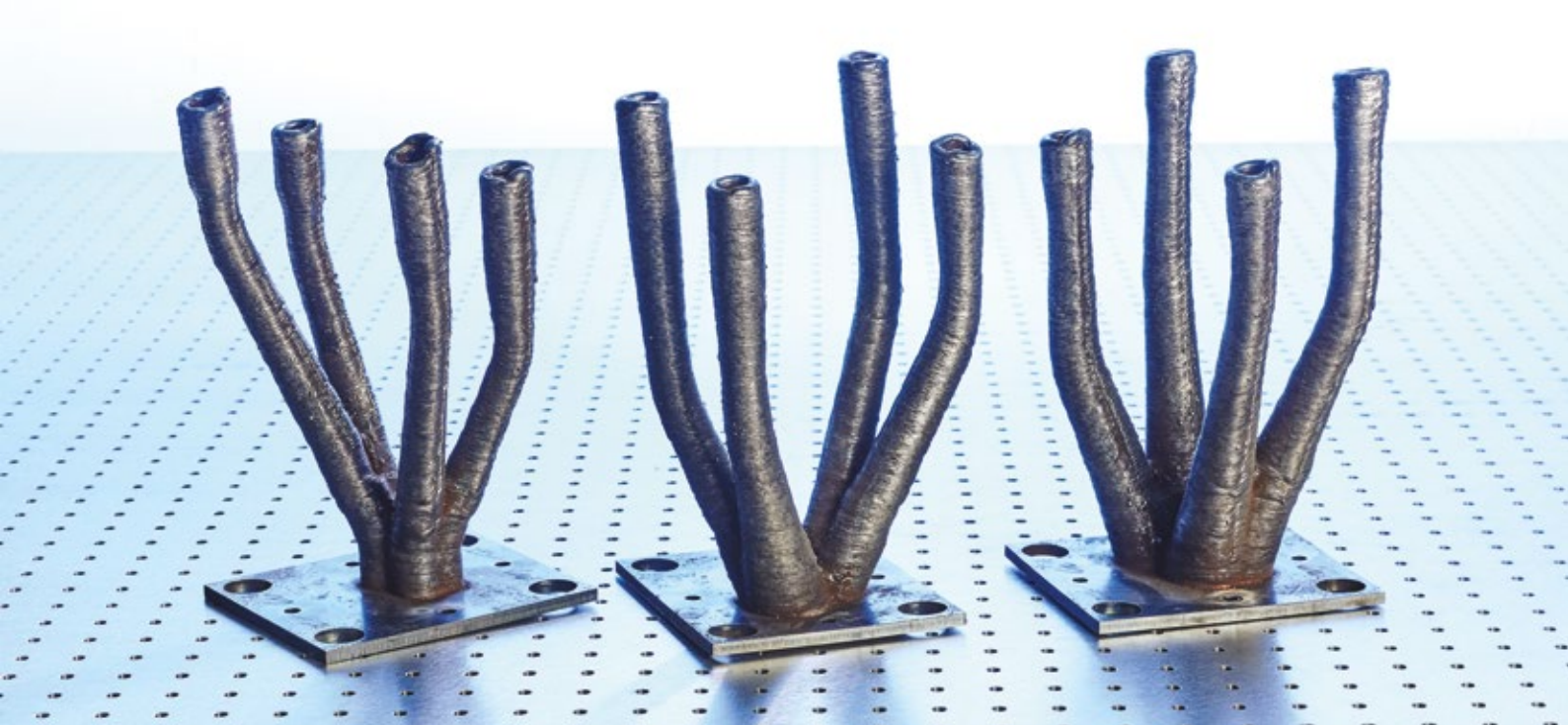
A „TU Ilmenau” által gyártott alkatrésztartók
